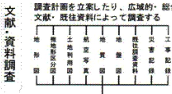
文献・既往調査資料から推定される地盤および地下水環境と建設工事および地盤防災との関連から各種調査手法を適宜組み合わせて現地調査を行う。
